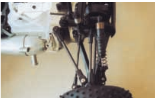
Für vielfältige Einstellmöglichkeiten in Spur, Sturz und Nachlauf sorgt diese aufwändige Vorderachse
